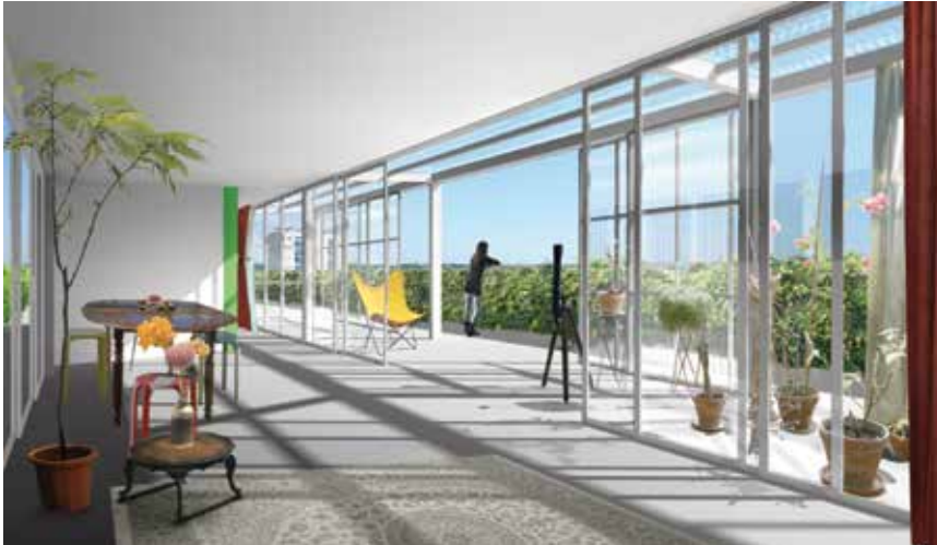
Zahvaljujući dvostrukom fasadnom sustavu, potrošnja energije smanjena je za 60 posto
